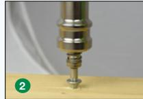
2 Verriegelung löst kurz vor Kopfauflage aus und gibt die Sicht frei auf den Schraubenkopf.
