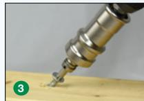
3 Auch bei schräger Verschraubung einsetzbar.
