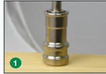
1 Sichere Verriegelung bis kurz vor Kopfauflage.
