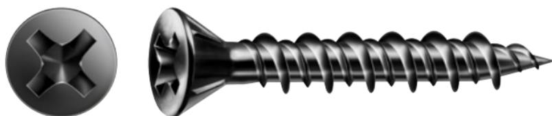
La vis GIX® Type-C est parfaite pour l'utilisation des panneaux de fibres-gypse. La stabilité est assurée par les fibres de cellulose à l'intérieur de la plaque de fibres-gypse, contrairement aux plaques de plâtre. Dans ce cas, le filetage (HiLo) est plus adapté. En effet, sa tête plus petite ainsi que son filetage renforcé permettent un vissage facilité.
