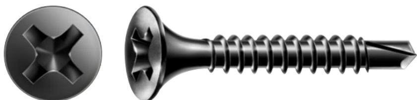
Dans les profilés de type métallique d'une épaisseur maximale de 2 mm tels que les profilés de renfort UA pour les portes ou pour les éléments de coffrage, la vis GIX® Type-D est parfaite grâce à sa pointe auto-foreuse.
