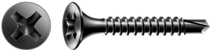
Bei Metallprofilarten, die nicht dicker als 2 mm sind, wie UA-Aussteifungsprofile für Türen oder bei Vorwandelementen hilft die GIX® Typ-D mit ihrer Bohrspitze.
