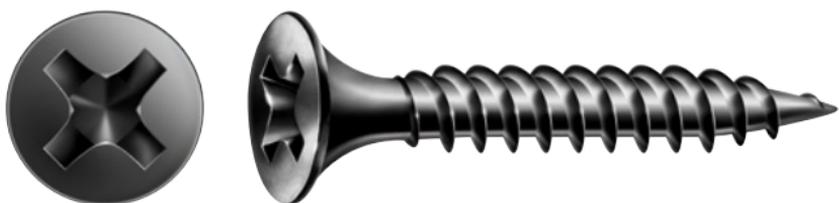
Mit der GIX® Typ-A Trockenbauschraube lassen sich Gipskartonplatten schnell und einfach an Metallprofile (CW, UW, CD, UD) verschrauben, die nicht dicker als 0,7 mm sind.
