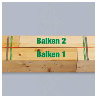
Balken verlängerung mit Überlappung (Ausklinkung) Querkzugverstärkung
